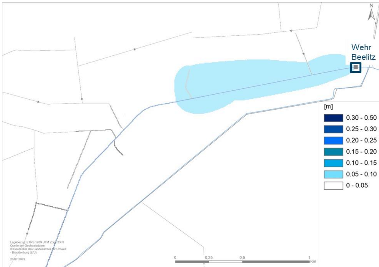
Abbildung 3-9: Differenz der Grundwasserstände in [m] zwischen Szenario 2 (Stauziel 1,3 m) und Szenario 1 (Stauziel 1,2 m).
